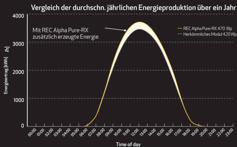
Berechnungen basierend auf Simulationsergebnissen für ein gesamtes Kalenderjahr mit einer 1,2-kWp-Anlage in Palm Springs, Kalifornien, USA. Differenz des Spitzen-Energieertrags von REC Alpha Pure-RX um 1,2 Uhr: +6 % mit einem um 5,7 % höheren Gesamtjahresertrag. Die tatsächliche Leistung kann je nach Standortbedingungen variieren.
