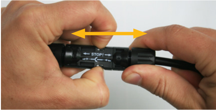
Abb. 4: Trennen eines Steckverbinders des Typs MC4 mit Werkzeug (Multi-Contact oder Hosiden)
