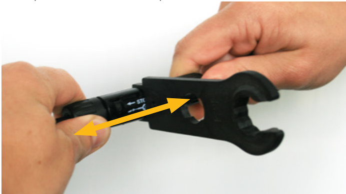
Abb. 4: Trennen eines Steckverbinders des Typs MC4 mit Werkzeug (Multi-Contact oder Hosiden)
