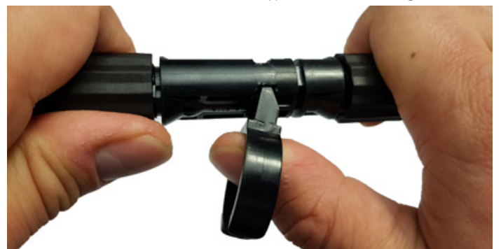
Abb. 8: Trennen von Steckverbindern des Typs MC4 Evo2 und Tonglin
