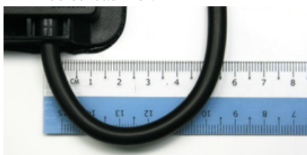
Abb. 9: Beispiel für falsche und richtige Biegung eines Kabels beim Verlassen der Junction Box.
