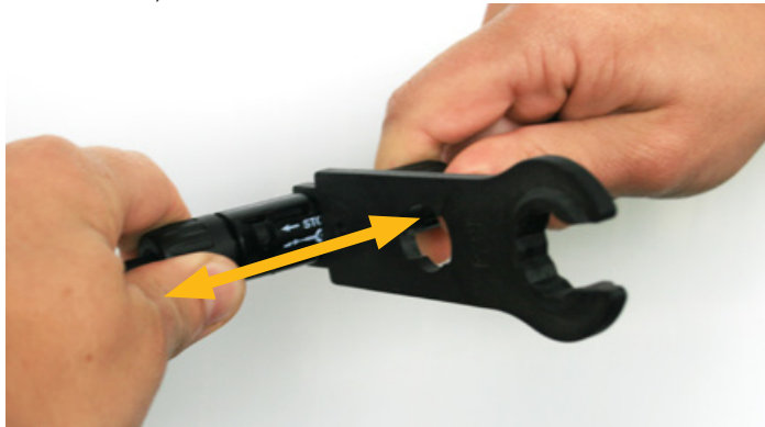
Abb. 4: Trennen eines MC4-Steckverbinders mit Werkzeug (Multi-Contact oder Hosiden)
