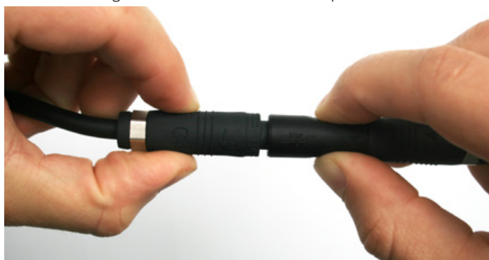
Abb. 5: Verbindung von Radox-Steckverbindern mit Spalt von ca. 2 mm
