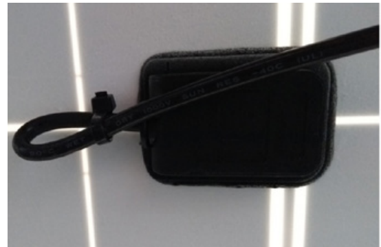
Abb. 9: Beispiel für ein Kabel, das die Junction Box unter einem extremen Winkel verlässt
