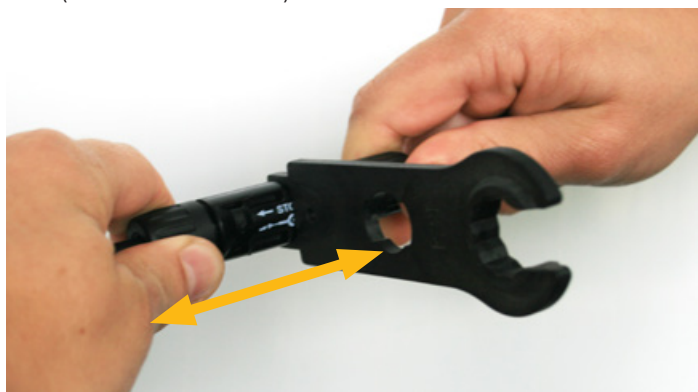
Fig. 4: Desconexión con una herramienta de un conector de tipo MC4 (Multi-Contact u Hosiden)
