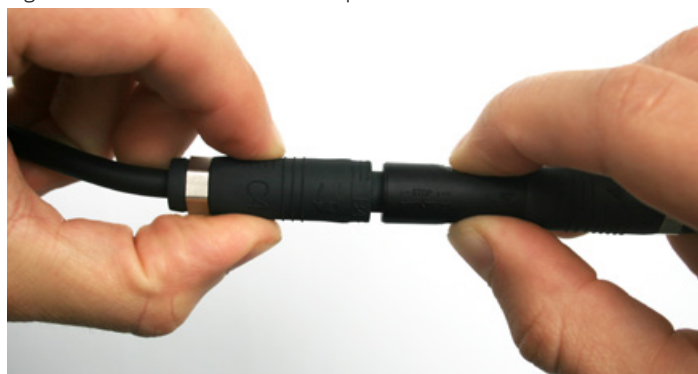
Fig. 5: Conexión de conectores Radox que muestra una distancia de ~ 2 mm
