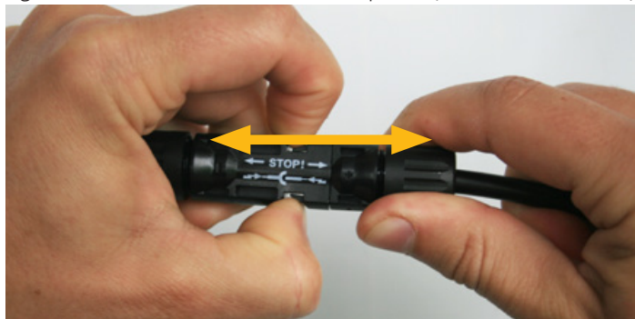
Fig. 4: Desconexión con una herramienta de un conector de tipo MC4 (Multi-Contact u Hosiden)
