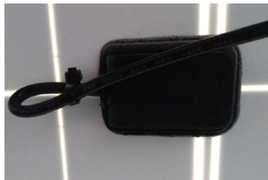
Fig. 10: Ejemplo de cable saliendo de la caja de conexiones en un ángulo extremo
