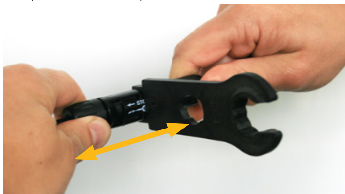
Fig. 4: Desconexión con una herramienta de un conector de tipo MC4 (Multi-Contact u Hosiden)
