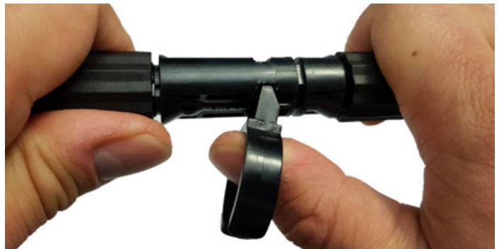
図8: MC4 Evo2およびトンリン社製コネクタの切断
