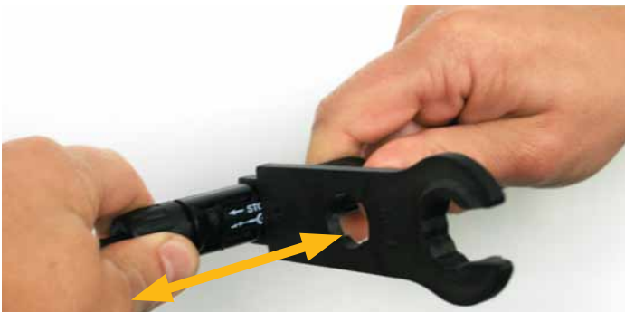
図6: 工具によるコネクタの切断 (ホシデン社製コネクタおよびマルチコンタクト社製 MC4コネクタ)
