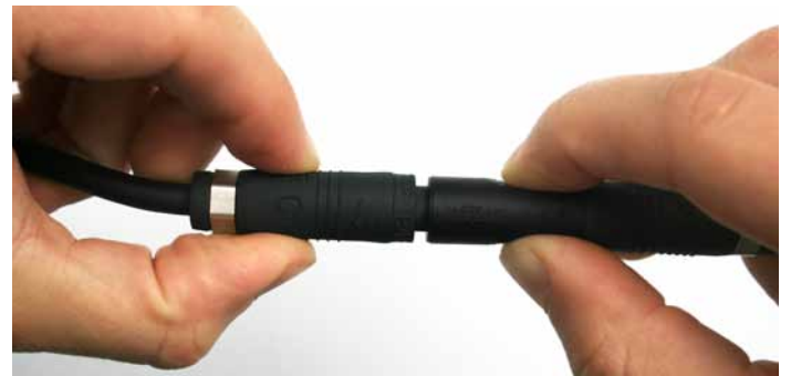
図 1: ラドックスコネクタの接続 ~2 mm の間隔
