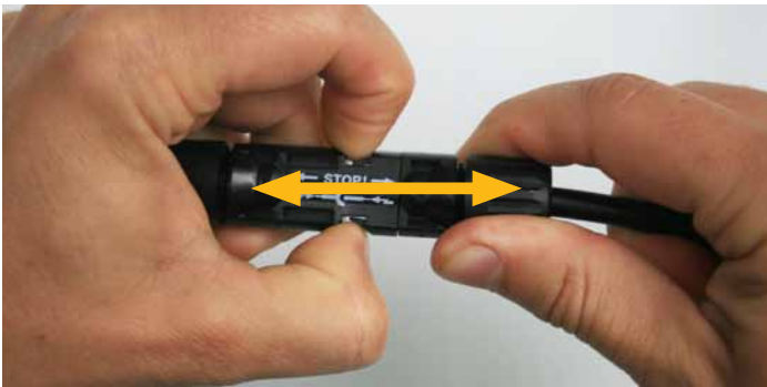
図5: 指によるコネクタの切断 (ホシデン社製コネクタおよびマルチコンタクト社製 MC4コネクタ)
