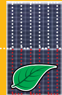
Wenn ein REC TwinPeak Modul verschattet wird, behält es weiterhin die Hälfte der Fläche für die Stromerzeugung.
