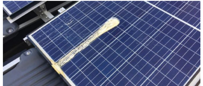
画像4: テンガ貯水池のフローティング試験システムでの鳥の糞によるひどい汚れの例(セルのシェーディングにより電力損失を招く恐れがあることは明白です)
