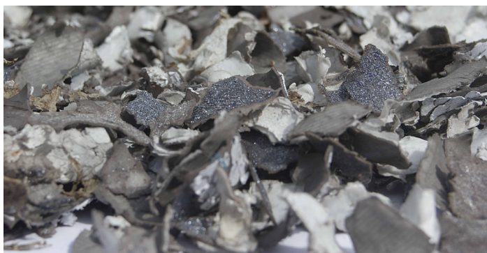
イメージ6: バックシートを含むソーラーモジュールから回収されたプラスチックはリサイクル可能。(提供: Butenhoff Werbeagentur & Verlag)
