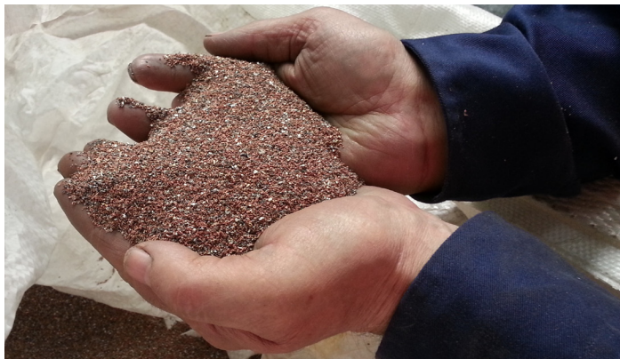
イメージ6: バックシートを含むソーラーモジュールから回収されたプラスチックはリサイクル可能。(提供: Butenhoff Werbeagentur & Verlag)
